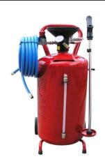
Пеногенератор работает от сжатого воздуха (4-6 атм.). Позволяет наносить моющие и дезинфицирующие растворы в виде пены на любые поверхности и на труднодоступные участки. Максимальная высота нанесения пены до 5 метров, максимальная длина до 10 метров.
